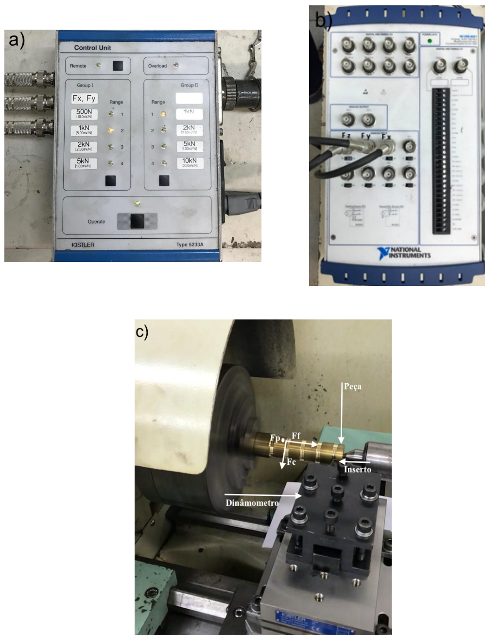
Figura 3.4: Montagem do sistema de aquisição de forças de usinagem: (a) amplificador de sinal, (b) placa de aquisição de dados e (c) dinâmômetro e peça montados no torno.
