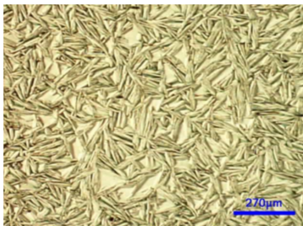
Figura 2.10: Martensita não maclada com porções de austenita retida em uma liga de NiTi (ABSI, 2013)
